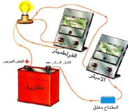
شكل يوضح الدائرة الكهربائية العملية
